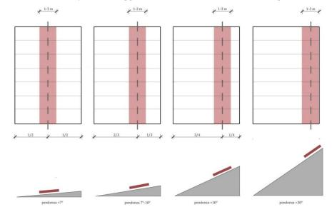
Rappresentazione schematica della zona di posizionamento delle graffette fisse in funzione all'inclinazione della falda
